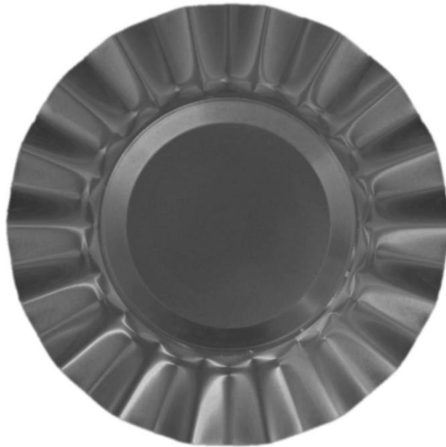
Рисунок 1.3–Искажение формы заготовки в процессе деформации
