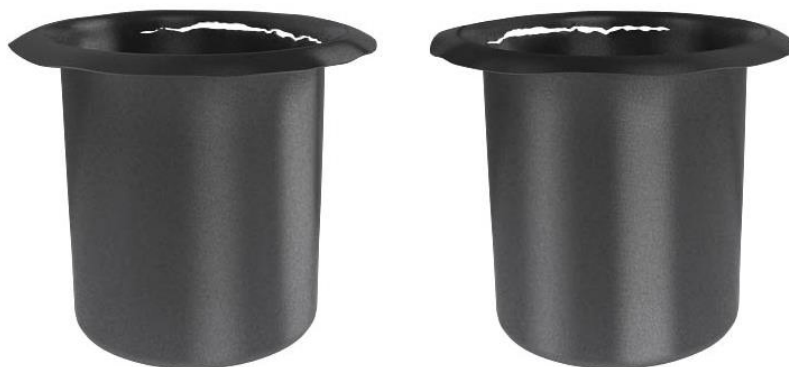
Рисунок 3.8 - Заготовки с кольцевыми трещинами, возникшими в процессе вытяжки
